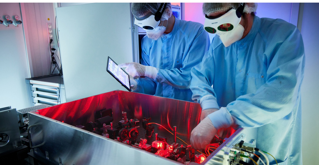
Justage des Konverters mithilfe eines abgeschwächten roten Lasers zur Emulation der Einzelphotonen.
