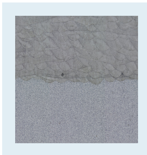
1 Übergang zwischen LPBF-Bereich (oben) und gegossenem Grundbauteil. 2 Mikrostruktur der Anbindungszone zwischen Grundwerkstoff und LPBF-Bereich.
