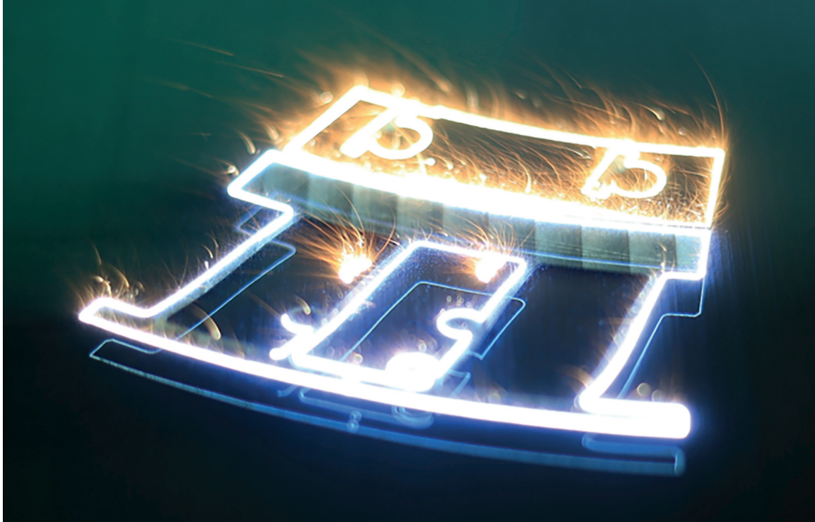
Belichtung eines Inlet Guide Vane (IGV) im LPBF-Prozess.
