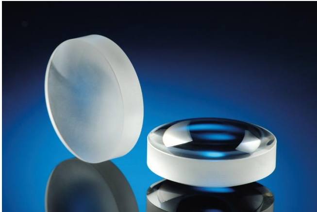
Bild 2: Eine Quarzglasoptik vor und nach der Laserpolitur. © Fraunhofer ILT, Aachen.
