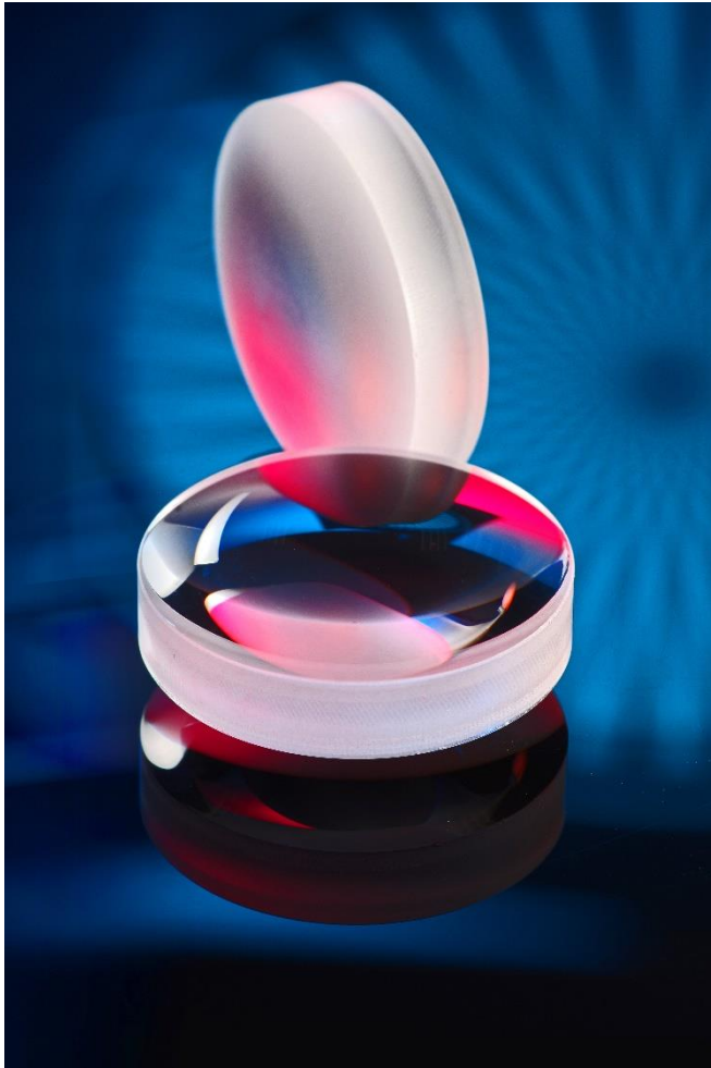
Bild 1: An den Oberflächen der geschliffenen Asphäre hinten streut das Licht. Vorne ist die gleiche Optik im laserpolierten Zustand zu sehen. © Fraunhofer ILT, Aachen.
