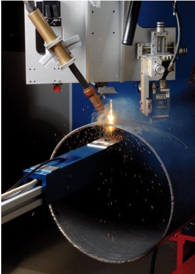
Bild 2: Prozessüberwachung und adaptive Regelung für das Laser-MSG- Hybridschweißen. © Fraunhofer ILT, Aachen.
