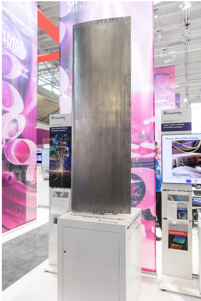
Bild 2: Mit dem UKP-Laser lassen sich großflächig winzige Bohrungen in Flugzeugflügel einbringen. Das reduziert den Luftwiderstand und ermöglicht bis zu 15 Prozent Treibstoffersparnis. © Fraunhofer ILT, Aachen / Klaus D. Wolf.
