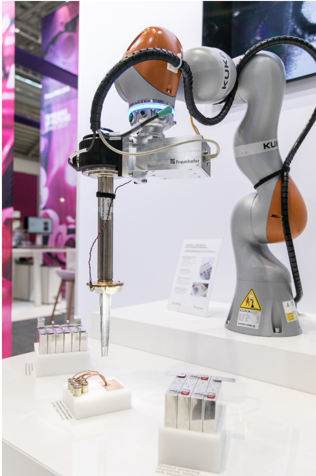
Bild 4: Laser ermöglichen in der Batterietechnik schon heute präzise und stabile Verbindungen: Mit dem Laserbonds lassen sich z. B. Kupferbändchen auf Batteriezellen schweißen. © Fraunhofer ILT, Aachen / Klaus D. Wolf.
