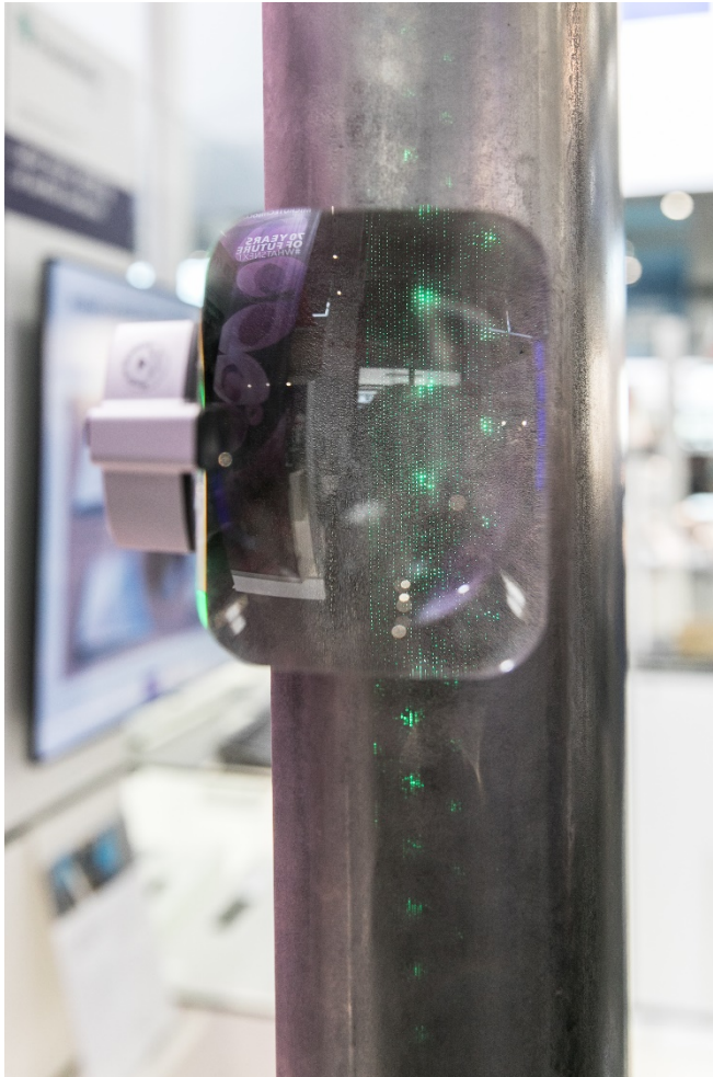
Bild 3: Durch die Lupe geblickt: Mit dem UKP-Laser gebohrte winzige Löcher in einem Flugzeugflügel des Industriepartners Sonaca. © Fraunhofer ILT, Aachen / Klaus D. Wolf.
