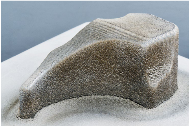
Bild 4: Schnell und präzise: Am Beispiel der additiven Fertigung eines Formbauteils mittels EHLA 3D konnte eine deutlich verkürzte Druckzeit im Vergleich zum LMD und LPBF demonstriert werden. © Fraunhofer ILT, Aachen.
