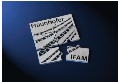
Abb. 1: Demonstratorbauteil für generative Fertigung durch 3D-Siebdruck
