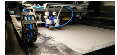
Abb. 2: Kinematik zur Integration von Komponenten in Bauteile während des Laserstrahlschmelzprozesses, eingebaut in eine Laserstrahlschmelzanlage
