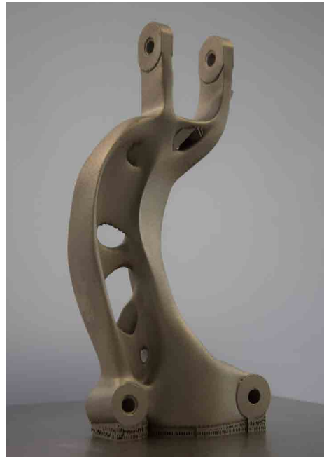
Abb. 1: Ressourcenoptimiertes Design einer KFZ-Dämpfergabel
