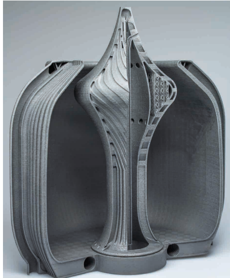
Abb. 1: Raketentriebwerk mit Aerospike, hergestellt durch Laser Powder Bed Fusion
