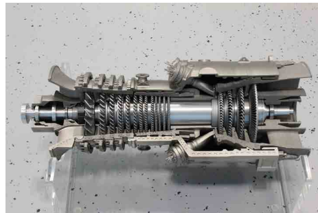
Abb. 1: Skaliertes Modell einer Gasturbine zur Stromerzeugung; komplett mit additiven Verfahren hergestellt.
