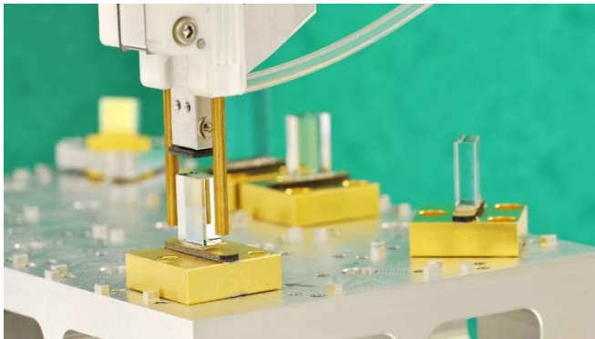
Bild 4: Lotbasierte Montage von Optiken für die langzeitstabile Strahlformung. Die Justage von Mikrooptiken soll künftig mithilfe von KI beschleunigt werden, um die für kommerzielle Kraftwerke erforderlichen Stückzahlen und Stückkosten zu erreichen. © Fraunhofer ILT, Aachen.
