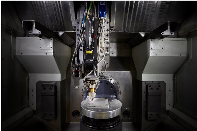
Bild 2: Versuchsanlage im H2GO-Projekt: Das Fraunhofer ILT beschichtet auf einer EHLA-Anlage Bauteile für Brennstoffzellen schnell und präzise mit Verschleißschutzschichten, um den Einstieg in die Großserie vorzubereiten. © Fraunhofer ILT, Aachen.
