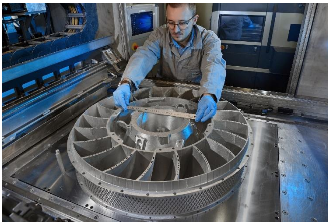
Bild 4: Die Luft- und Raumfahrt gehört zu den Profiteuren der aktuellen Entwicklung im metallischen 3D-Druck. Kleine Stückzahlen und hohe Komplexität leichter, leistungsfähiger Komponenten gehören schon heute zu den Stärken der Additiven Fertigung. © Fraunhofer ILT, Aachen.
