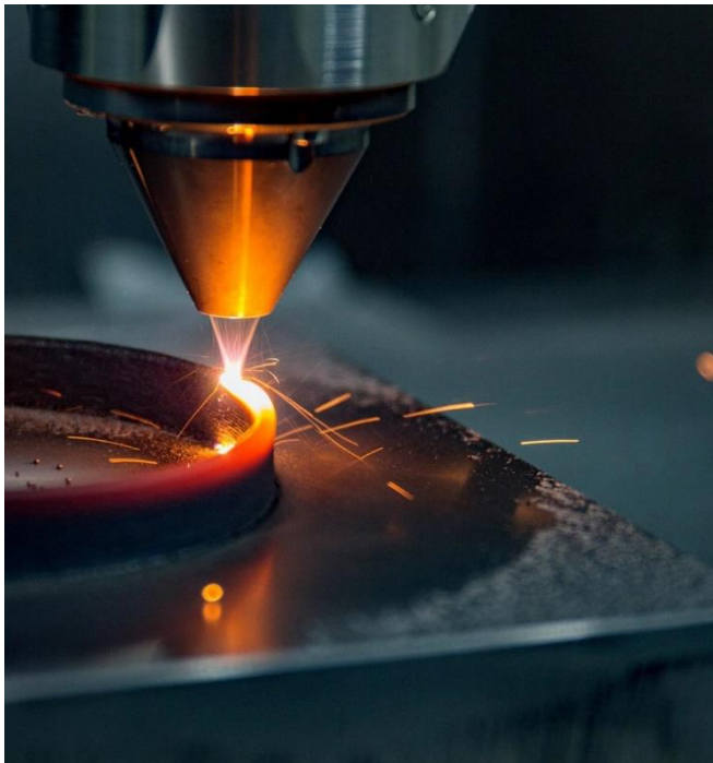
Bild. 2: Der neue Produktions- prozess mit der EHLA3D- Technologie ermöglicht es, komplexe Geometrien mit hochfesten Materialien effizient zu produzieren, zu beschichten oder zu reparieren. © Makino.
